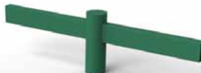
PROYECT 2 Brazo recto doble de longitud 1.20 m de sección rectangular para 2 ó 3 proyectores. Acoplamiento en columnas de diámetro en punta 78 mm.
