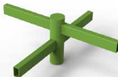
PROYECT 4 Brazos rectos dobles de longitud 1.20 m de sección rectangular para 4 proyectores. Acoplamiento en columnas de diámetro en punta 78 mm.
